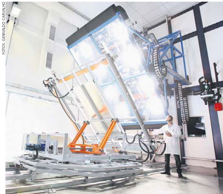
Simulador solar, que reproduz a incidência dos raios solares para aquecimento de água
