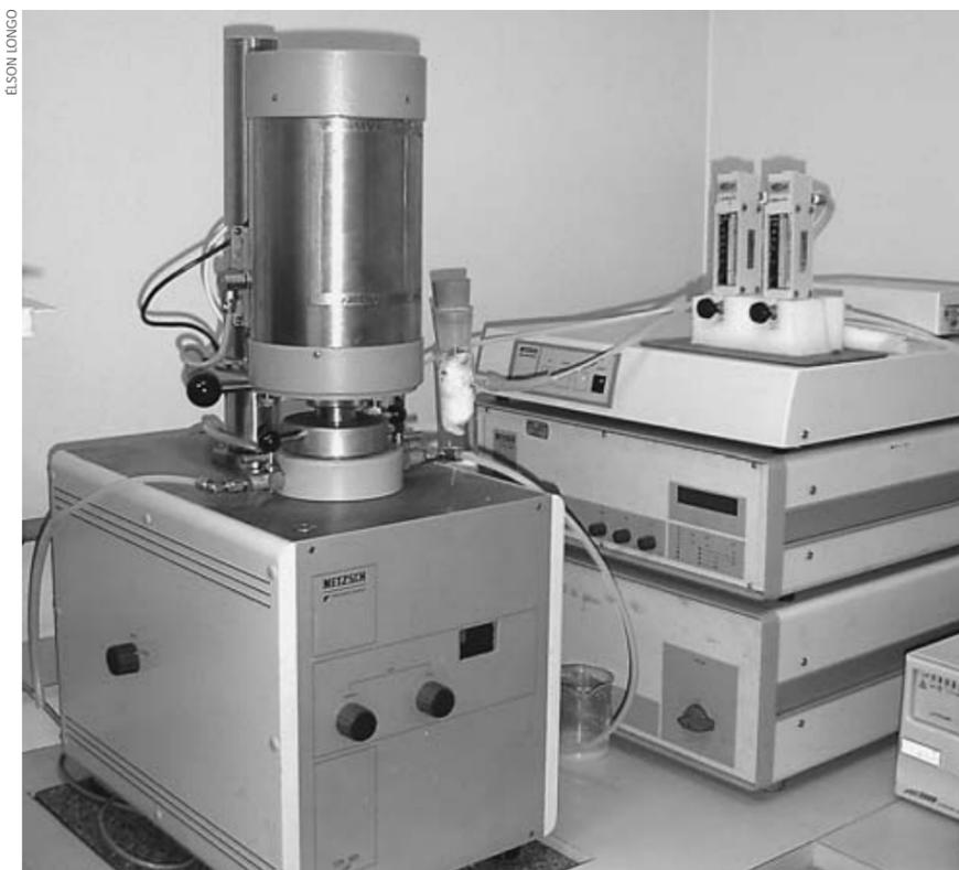
Equipamentos usados para determinar a perda de massa em materiais nanoestruturados
