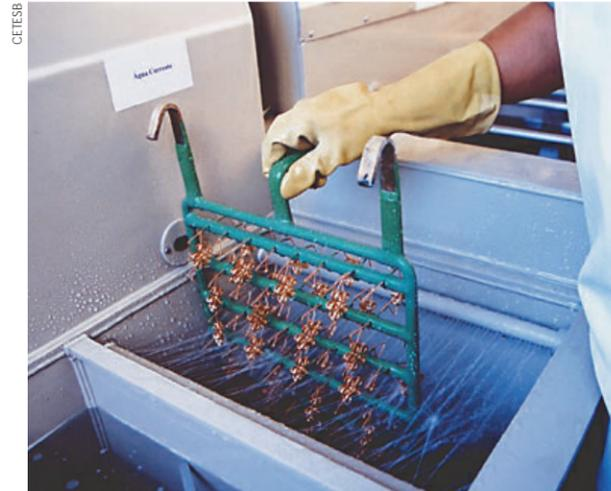
Exemplos de P+L: bateria de equipamentos em curtume e enxágüe com aspersores para redução do consumo de água em indústria de bijuteria
