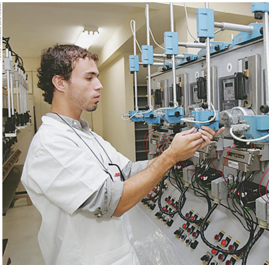
No laboratório de medidores, da AES-Eletropaulo, técnico faz a aferição de equipamentos
