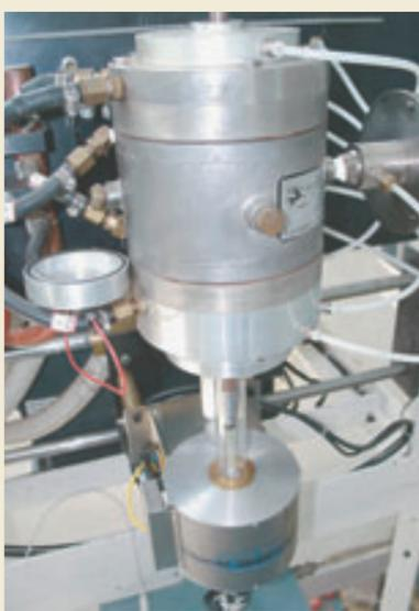
Forno de raios ultravioleta da torre de puxamento, que derrete o vidro que origina a fibra óptica
